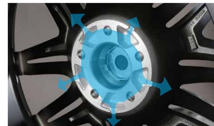
錆びや汚れによるホイールの劣化を防ぐ水抜き加工
