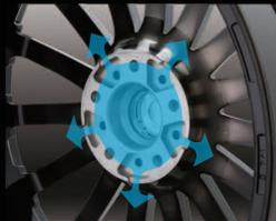
センター部から侵入した水分を排するため排水加工を施し、水分が外部に排出されやすい形状。
