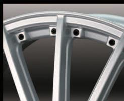
シャープで繊細なスポークを両脇から挟みつつ、小径のヒアスボルトでリムにガッチリと接合される形状。
