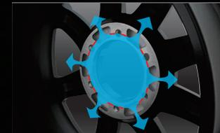
センター部から侵入した水分を排出するよう裏面(赤ライン)に加工を施し、水分が外部に排出されやすくしています。
